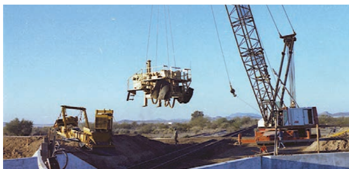
Триммер построен по модульному принципу, поэтому компоненты можно снимать, чтобы уменьшить вес триммера и укладчика для подъема и транспортировки в соответствии с имеющимися кранами и трейлерами.
