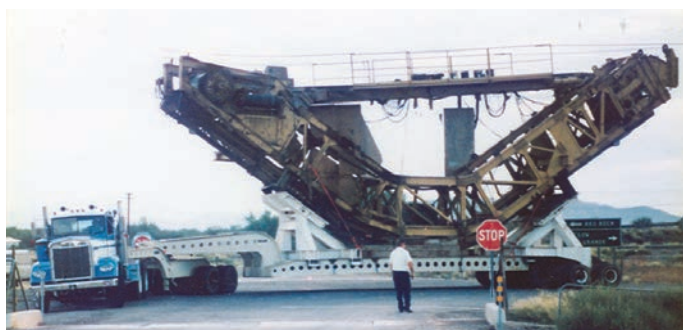
Специальный мощный трейлер, модифицированный для перемещения триммера и укладчика на большие расстояния.
